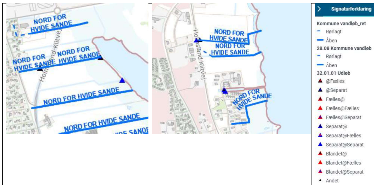
Figur 2: Visende spildevandsudløb fra spildevandsplanen. Der udledes regnvand til Vandløb 3 og 31.
